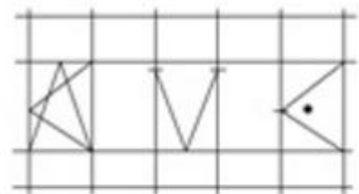
Intégration d'ouvrants : française, italienne, oscillo-battant, accès pompiers
